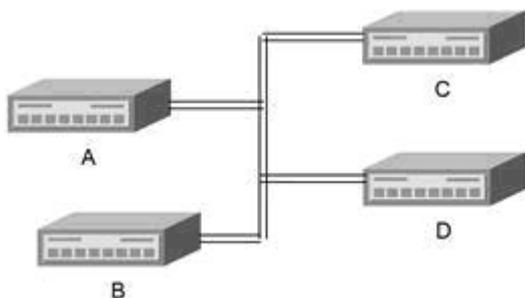
Em ligações ponto a ponto ponto a ponto: SPI, RS232... Ligações multiponto : I2C, USB, RS422, RS485, CAN (Controller Area Network).
